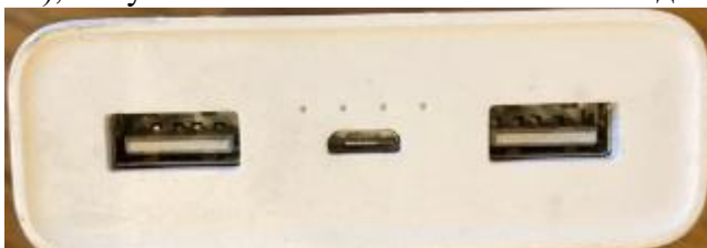
Рисунок 1 PowerBank MI Bank 2C панель портов (толщина 2см, ширина 8 см)
